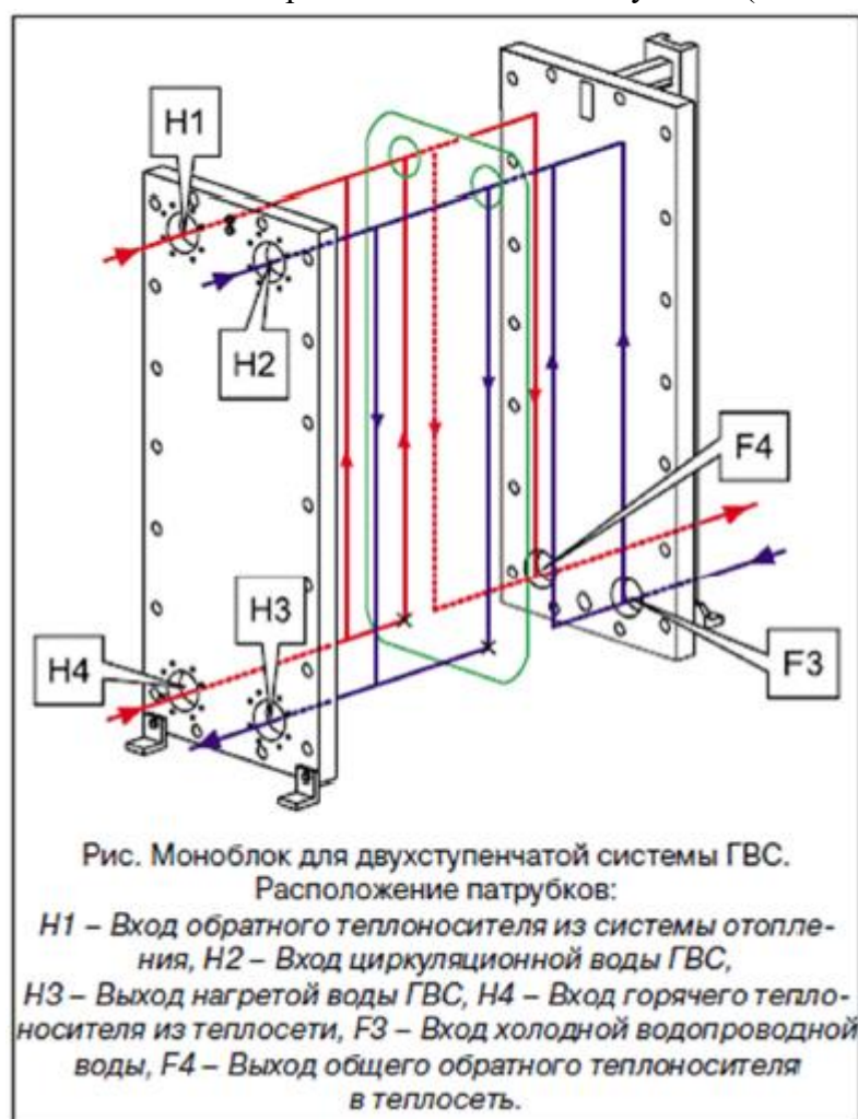
Рисунок 2. Моноблок для двухступенчатой системы ГВС
